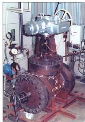
■600A仕切弁による実証試験実施状況(写真2)
