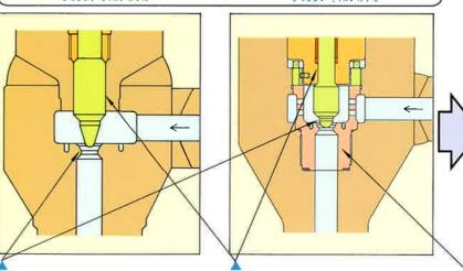
肘型逆流形式とし、弁座シール部 は絞り部と分離し、シール面及び 絞り部は耐蝕性の高い表面硬化肉 盛りを行い流路のあらゆる面の浸 蝕を最小にします。
